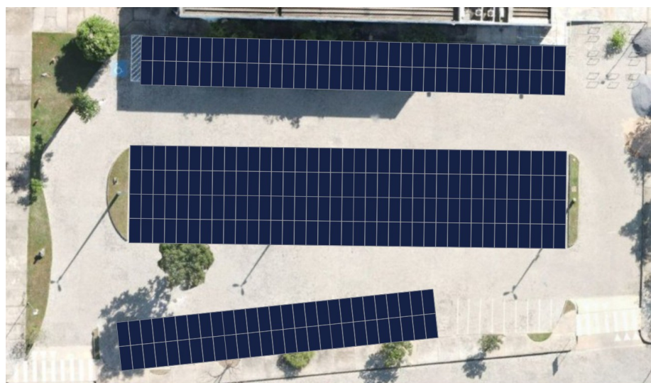
Figura 65 - Disposição dos painéis no estacionamento em frente ao centro de biblioteca
