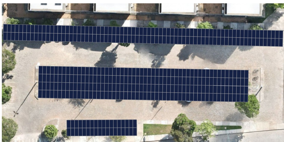
Figura 66 - Disposição dos painéis no estacionamento em frente ao Prédio dois
