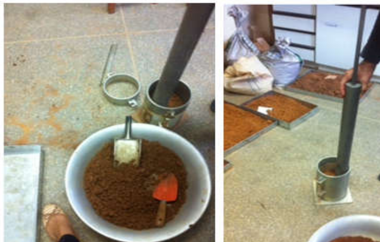
Figura 16- Compactação das amostras.
