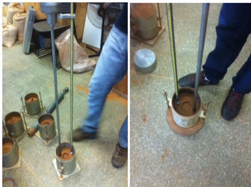
Figura 18- Ensaio DCP no laboratório
