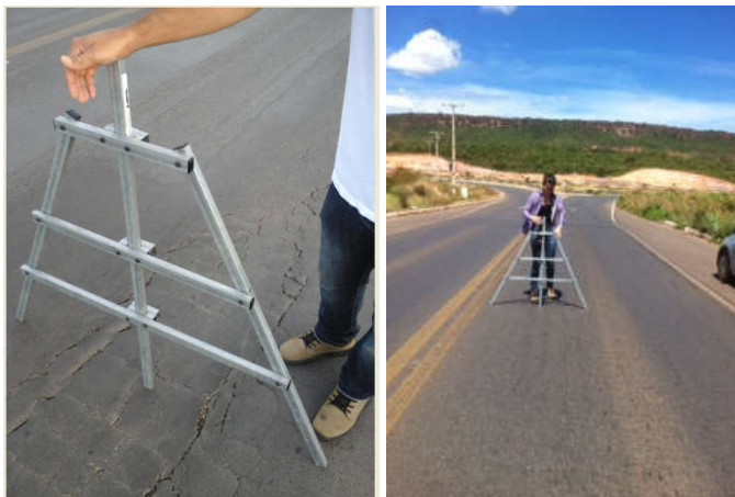
Figura 19- Treliça para realização das medidas de deflexões das trilhas de roda
