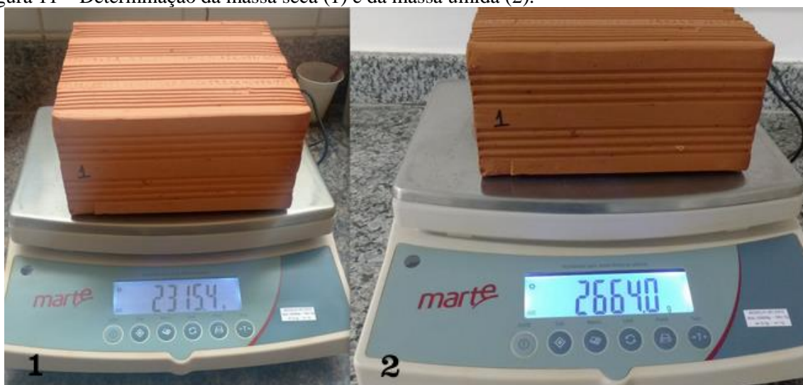
Figura 11 – Determinação da massa seca (1) e da massa úmida (2).
