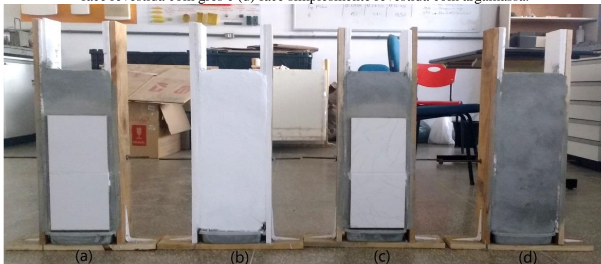
Figura 18 – Protótipos 02: (a) face revestida com porcelanato, (b) face pintada com tinta branca, (c) face revestida com grês e (d) face simplesmente revestida com argamassa.
