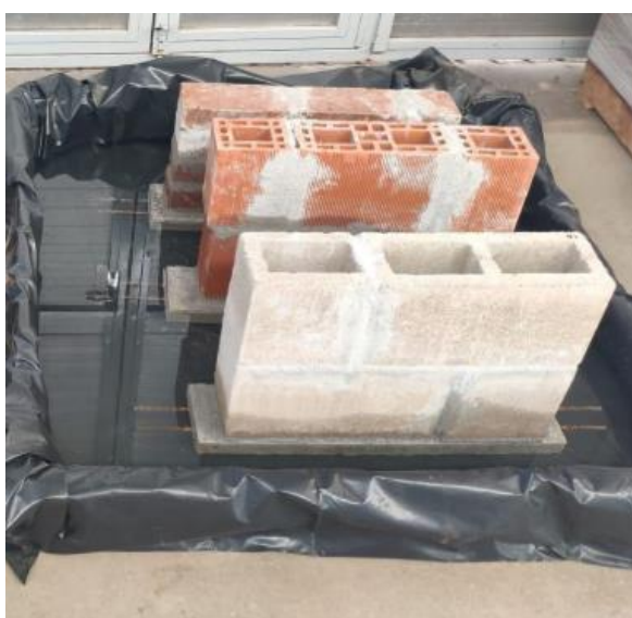
Figura 11 - Protótipos de parede submetidos a ensaio de capilaridade
