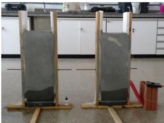
Figura 17 - Protótipos de parede sob ensaio de umidade ascensional
