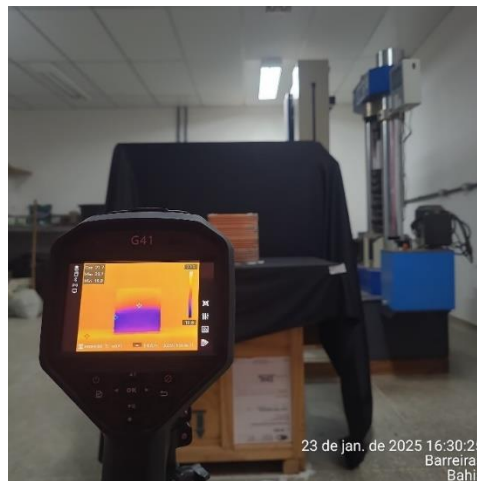
Figura 36 - Aferição de imagem termográfica no bloco
