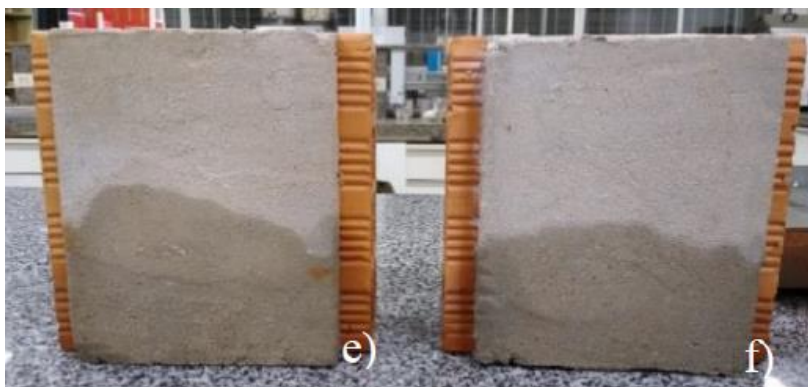
Figura 27 - Mancha de umidade presente nos blocos após serem ensaiados
