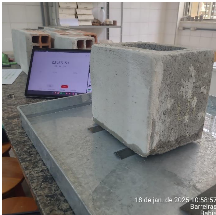
Figura 31 - Bloco monitorado durante execução do ensaio de capilaridade
