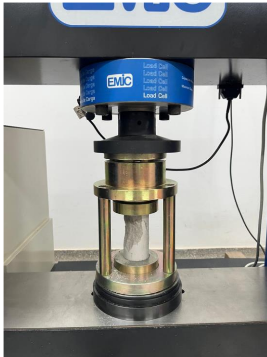
Figura 13 - Corpo de prova após o ensaio de resistência à compressão.
