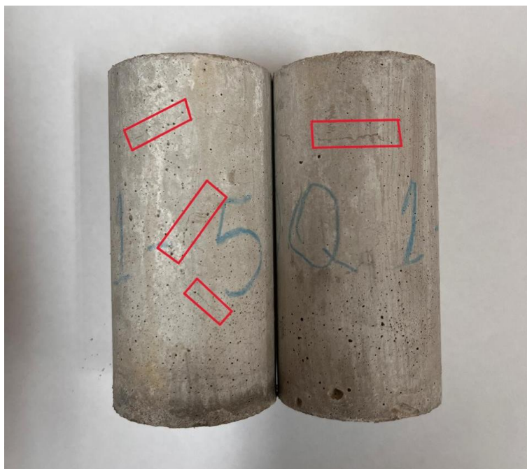
Figura 20 - Corpos de prova curados quimicamente apresentando fissuração na membrana forma pelo agente de cura
