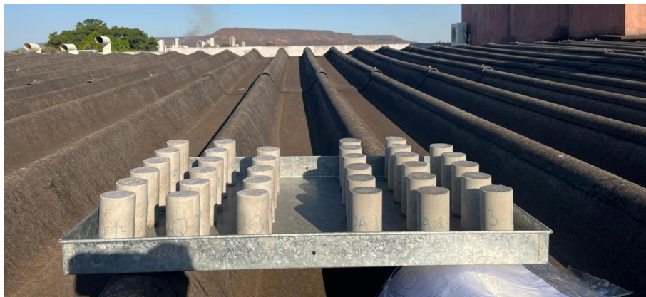
Figura 10 - Corpos de prova expostos em ambiente externo
