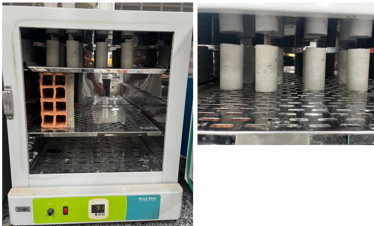
Figura 11 - Corpos de prova expostos em estufa à 105 °C. À esquerda, 4 CP's sem tratamento superficial. À direita, 4 CP's com aplicação do agente de cura química à base de hidrocarbonetos parafínico.
