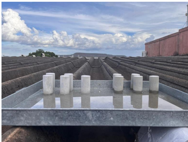
Figura 19 - Corpos de prova expostos ao ambiente externo em recipiente com lâmina d'água após chuva
