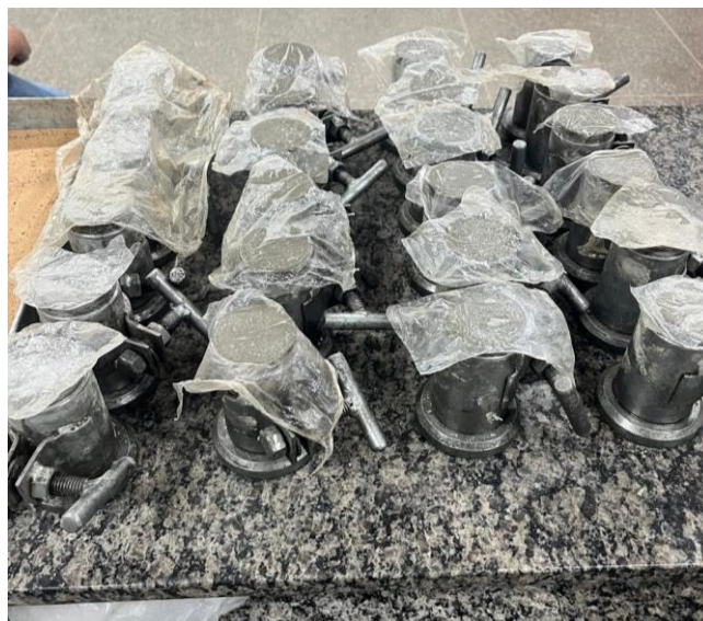
Figura 8 - Corpos de prova pós moldagem cobertos por filme de polietileno
