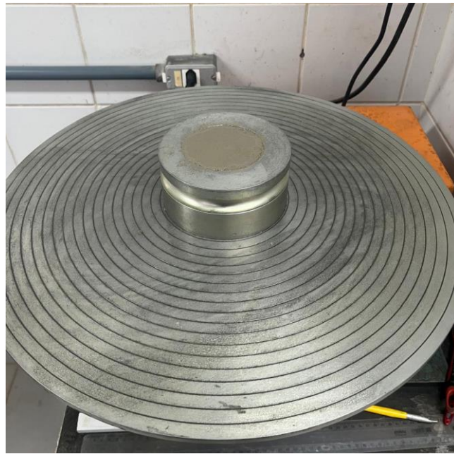
Figura 4 - Molde tronco-cônico preenchido com argamassa
