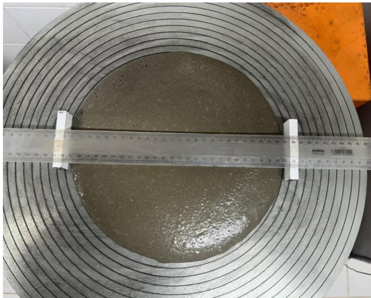
Figura 7 - Leitura do diâmetro da argamassa espalhada
