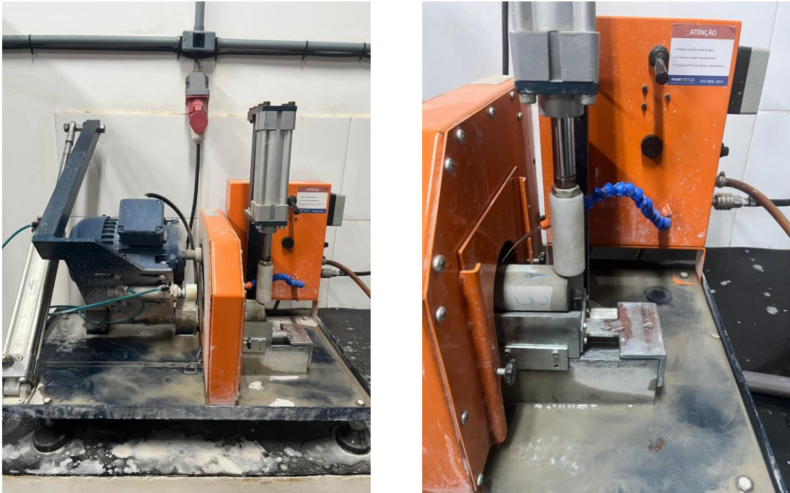
Figura 12 – Retífica utilizada para o preparo das superfícies planas dos CP's.
