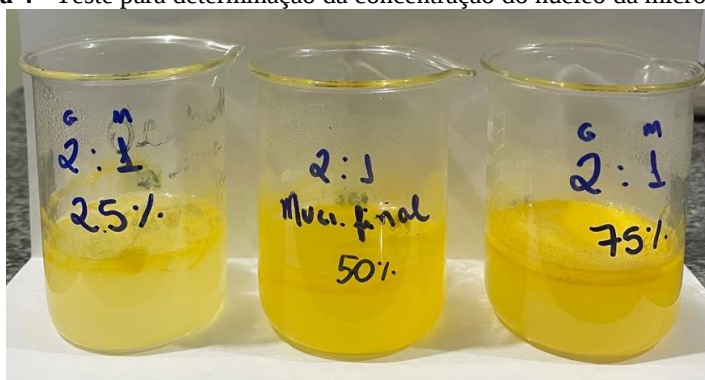
Figura 4 - Teste para determinação da concentração do núcleo da microcápsula
