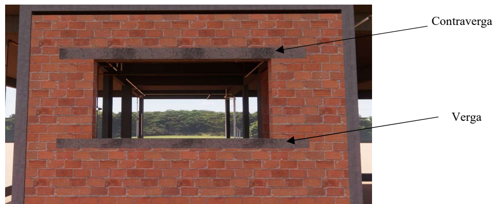
Figura 13 – Execução de verga e contraverga
