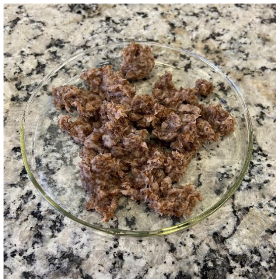
Figura 7 - Caroço de algodão moído (CM) após o pré-tratamento alcalino com NaOH
