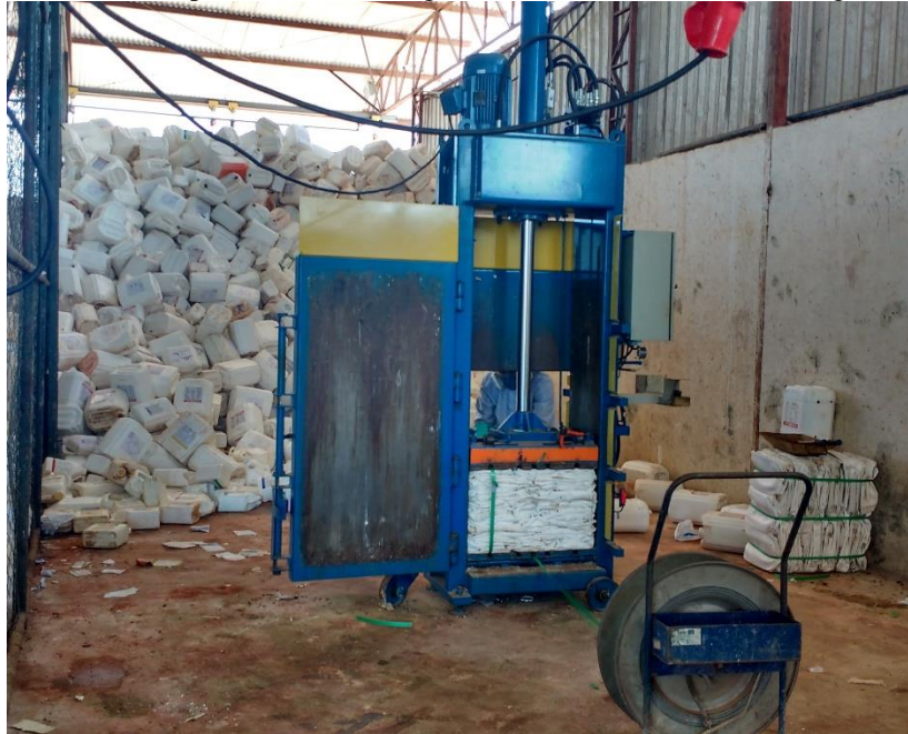
Figura 9- Funcionário compactando as embalagens de PEAD na unidade da Aciagri, Barreiras - Ba.
