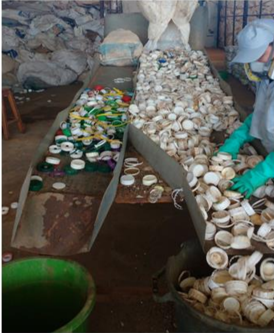
Figura 10 – Processo de separação de tampas. Fonte: Autoria própria Data: dezembro de 2018.
