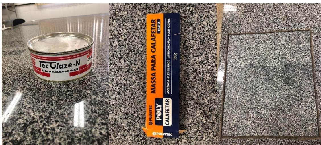
Figura 10 – Desmoldante/ Massa de calafetar/ Aplicação de ambos.
