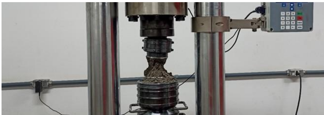
Figura 22: Ensaio de resistência a compressão em paver imediatamente após a ruptura.
