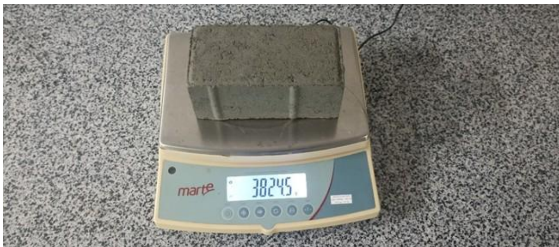
Figura 17: Determinação da massa saturada das amostras no ensaio de absorção de água, utilizando balança de precisão após o período de imersão no tanque.
