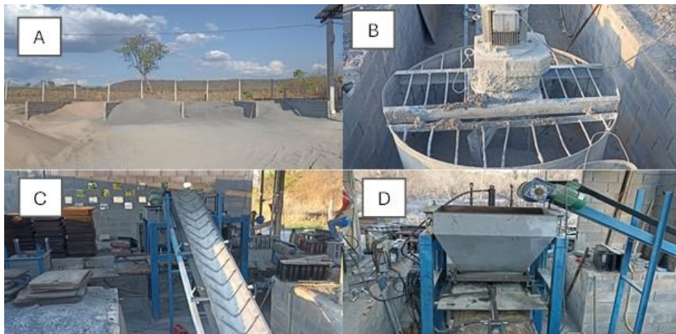
Figura 5: Registros em ambiente fabril com processo automatizado evidenciando os agregados nas baias de armazenamento (A), mistura (B), mecanismo de transporte (C) e moldagem (D).
