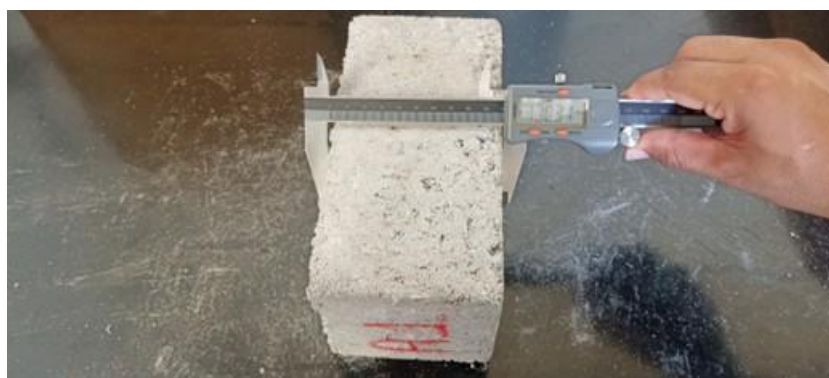
Figura 15: Verificação da espessura do paver por meio de paquímetro digital, utilizada para confirmar a dimensão vertical da peça.
