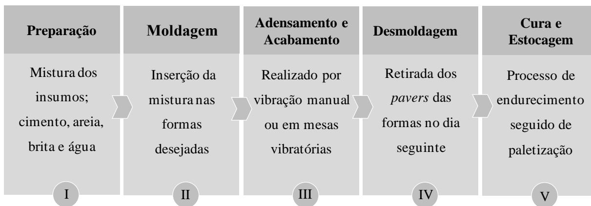
Figura 6: Fluxo genérico dos processos manuais de fabricação de pavers .
