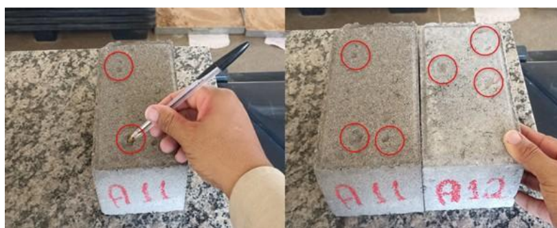
Figura 23: Identificação de cavidades na superfície de rolamento dos pavres da empresa A.
