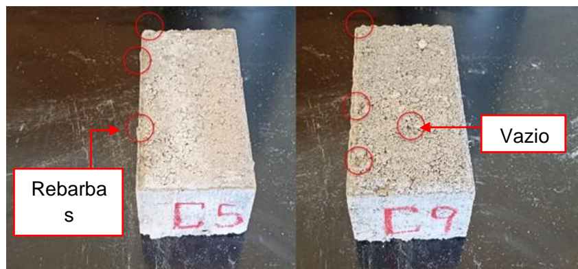
Figura 27: Comparação entre a peça com melhor acabamento superficial (à esquerda) e a peça com mais imperfeições (à direita), destacando a presença de falhas como rebarbas e microvazios.
