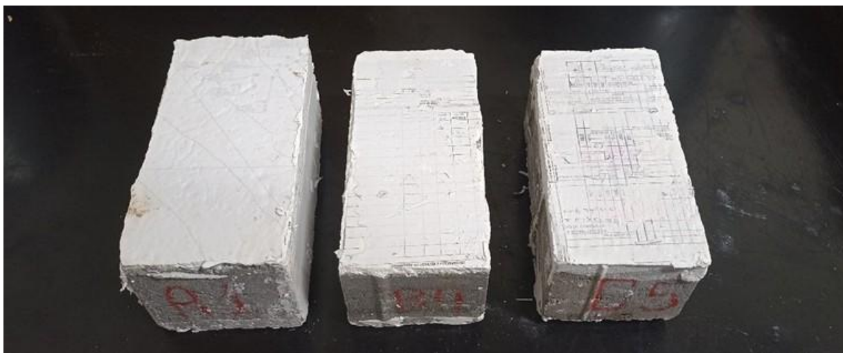
Figura 20: Exemplos de peças das empresas A, B e C devidamente capeadas, preparadas para o ensaio de resistência à compressão.
