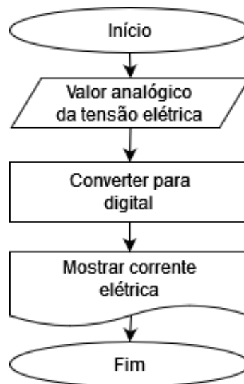
Figura 26 – Fluxograma para cálculo da corrente elétrica gerada
