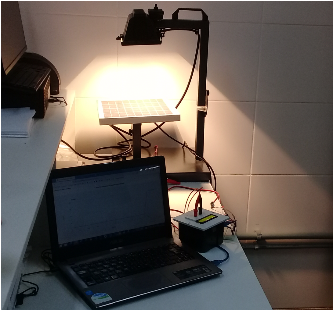
Figura 36 – Aquisição de dados no módulo fotovoltaico de 10 W
