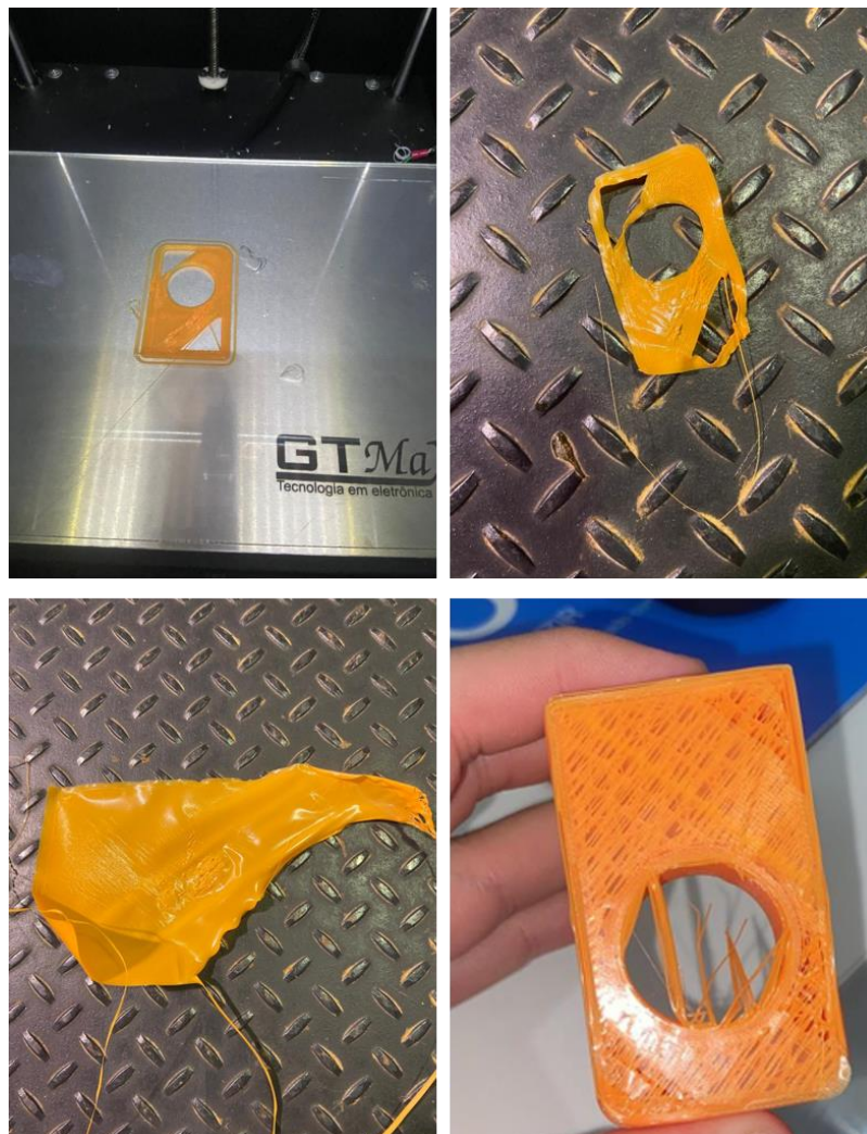
Figura 32 – Falhas apresentadas na impressão 3D
