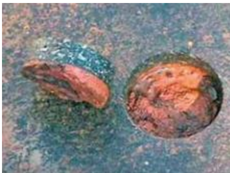
Figura 10. Corpo de prova de revestimento asfáltico.
