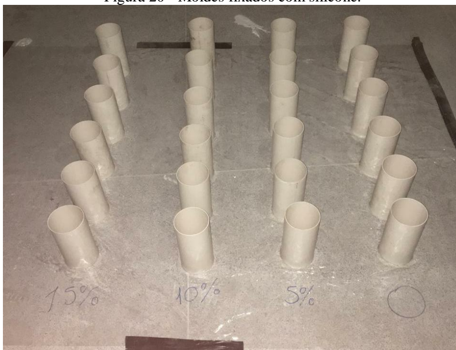
Figura 20 - Moldes fixados com silicone.
