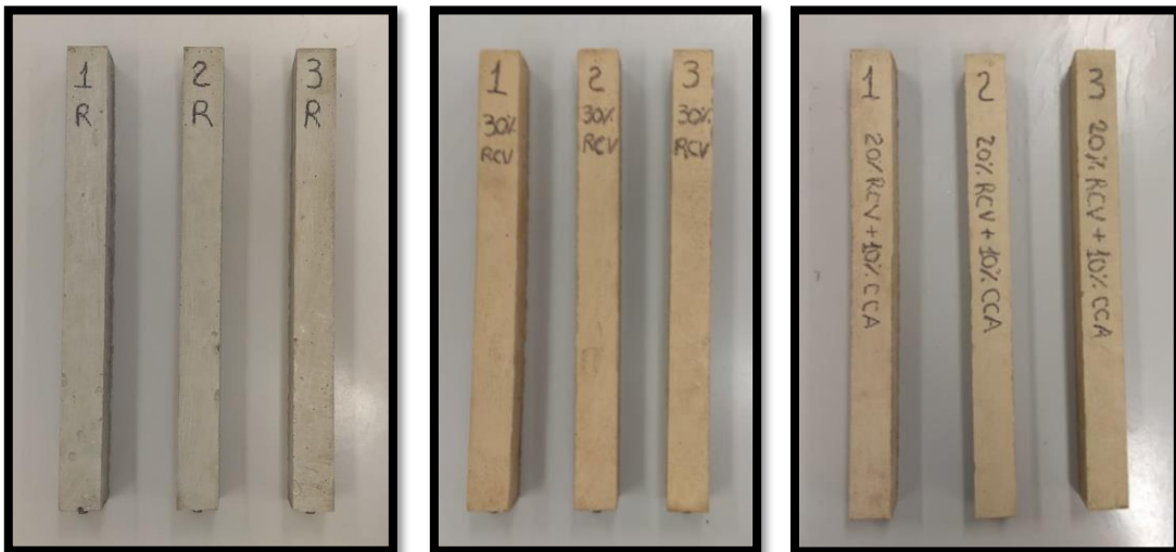
Figura 10: Corpos de prova prismáticos após a desmoldagem.
