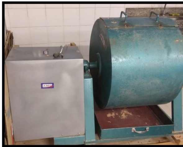
Figura 1: Equipamento de abrasão Los Angeles utilizado para a moagem do RCV.
