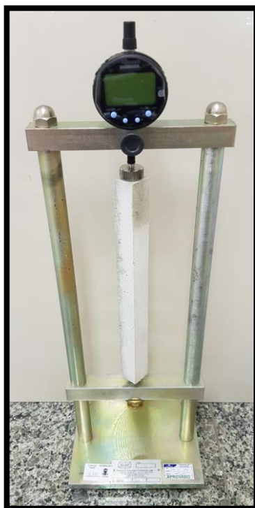
Figura 19: Pórtico comparador de comprimento utilizado no ensaio de variação unidimensional com corpo de prova prismático no momento da medição.
