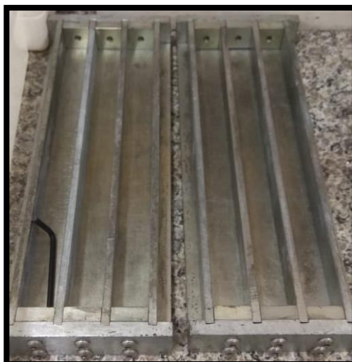
Figura 8: Moldes para produção de corpos de prova prismáticos.
