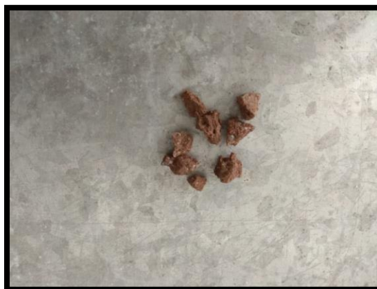
Figura 15: Amostras extraídas da região central dos corpos de prova, já submetidos ao ensaio de resistência à compressão, para ensaio de porosidade.
