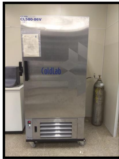
Figura 17: Ultrafreezer utilizado para a paralisação das reações de hidratação das amostras de argamassas.
