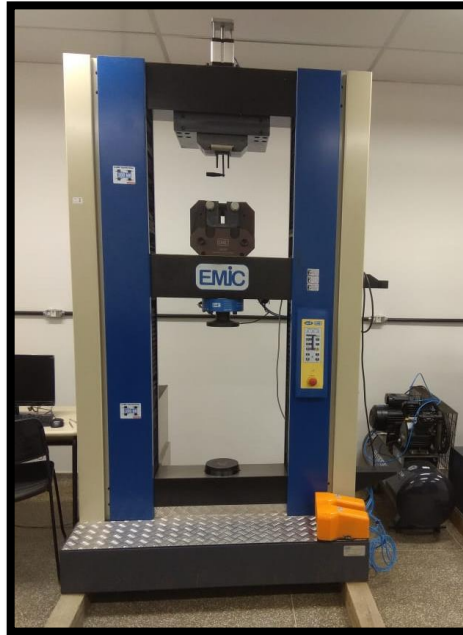
Figura 13: Máquina universal utilizada no ensaio de resistência à compressão axial.
