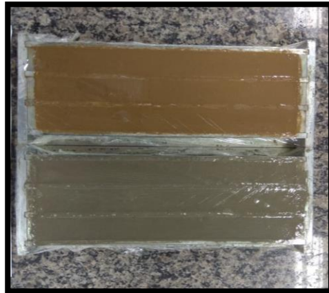
Figura 9: Corpos de prova prismáticos, da argamassa contendo 30% de RCV e da argamassa de referência revestidas com filme polimérico após a moldagem.
