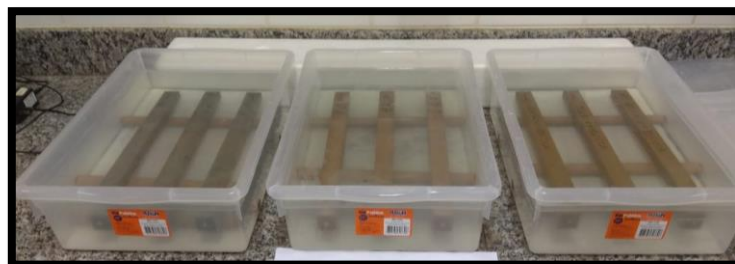
Figura 11: Corpos de prova submetidos à cura submersa em água saturada com cal, em recipientes fechados.
