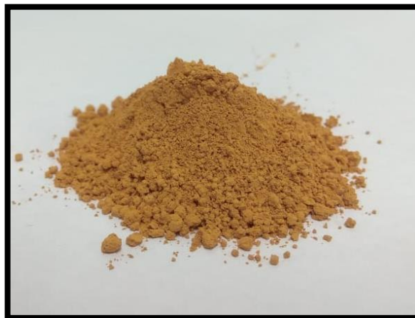
Figura 2: Aspecto do RCV cominuído após o peneiramento.
