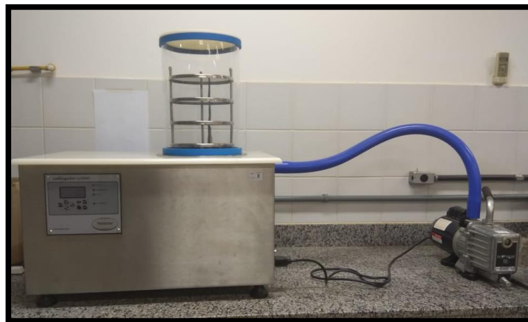
Figura 18: Liofilizador utilizado para a secagem, por sublimação, das amostras de argamassas.
