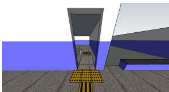
Figura 62 - Instalação de rampa junto ao vão da porta para tratamento de desnível.
