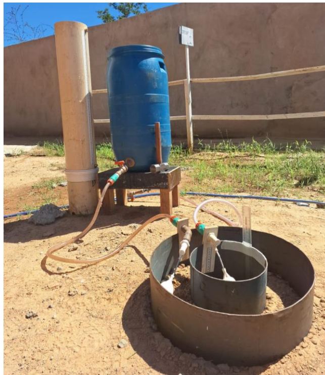
Figura 10 – Sistema semiautomático para ensaio de infiltrômetro de anel
