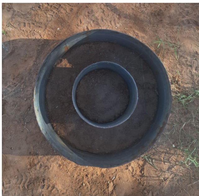
Figura 8 - Anéis concêntricos cravados para ensaio de infiltrômetro de anel
