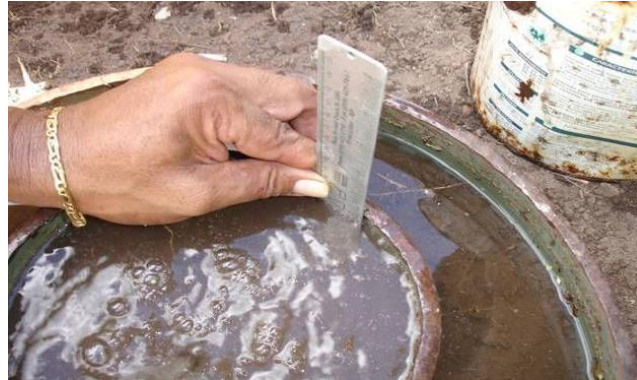
Figura 9 - Ensaio de infiltrômetro de anel convencional
