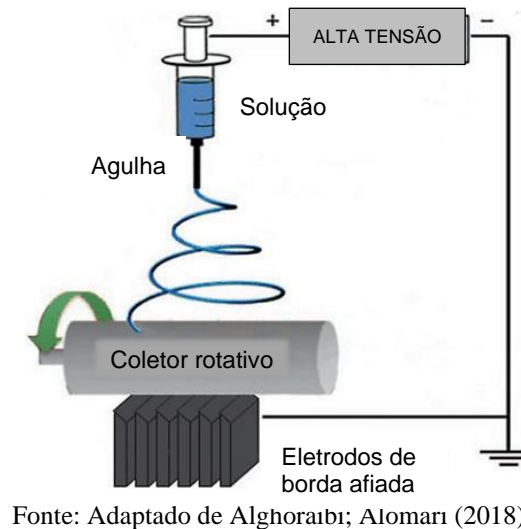
Figura 16 – Esquemática do processo de eletrofição com coletor de tubo rotativo com eletrodos de borda afiada
