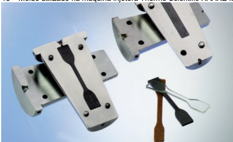
Figura 13 – Molde utilizado na máquina injetora Thermo Scientific HAAKE MiniJet II
