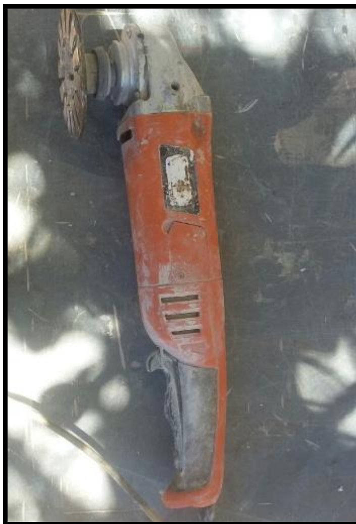
Figura 16 – Politriz utilizado para a retificação das peças pré-moldadas de concreto para pavimentação.
