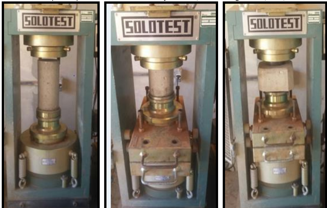
Figura 20 – Ensaio de resistência à compressão peça pré-moldada para pavimentação, e para corpos de prova cilíndricos com relação altura/diâmetro iguais a 1,0 e 2,0.
