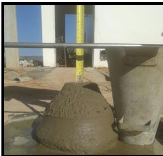
Figura 21 – Ensaio de abatimento do tronco de cone de um dos concretos estudados.
