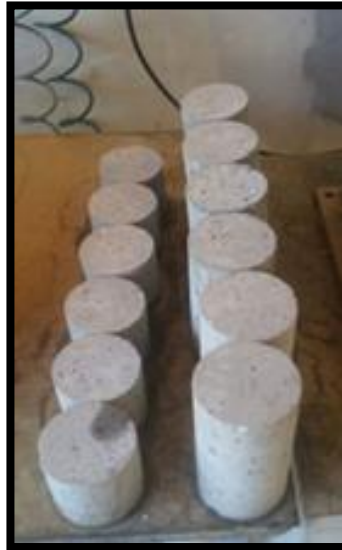
Figura 19 – Corpos de prova cilíndricos, de dimensões \varnothing 10 \times 20 cm e \varnothing 10 \times 10 cm, retificados para a realização do ensaio de resistência à compressão.
