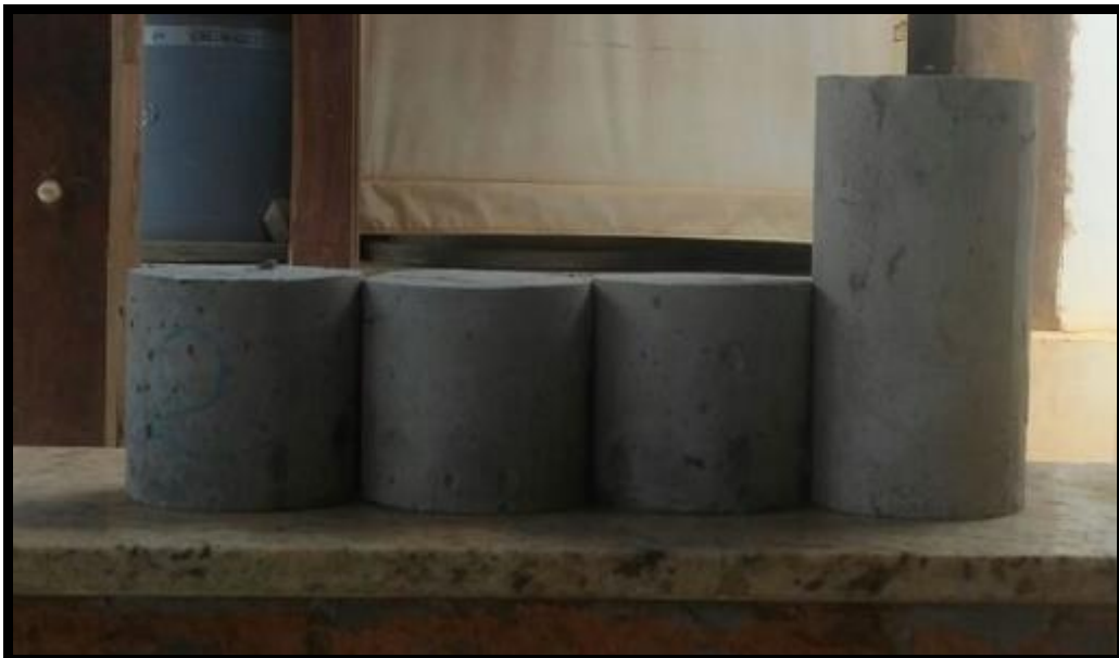
Figura 15 – Corpos de prova cilíndricos com relação h/d igual a 1,0 e 2,0.
