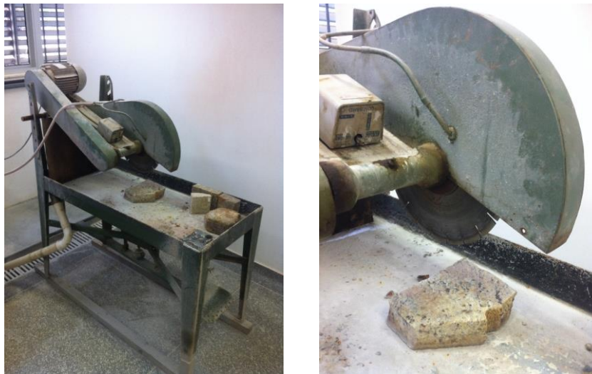
Figura 14 – Equipamento utilizado para o corte dos corpos de prova cilíndricos.
