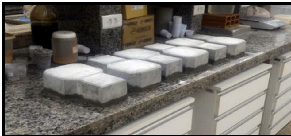
Figura 17 – Peças pré-moldadas para pavimentação capeadas com argamassa.
