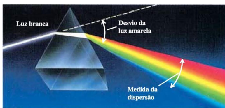
Figura 2: Dispersão da luz branca através de um prisma refrator.
